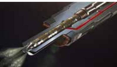
Injektor yang kotor menyebabkan semprotan bahan bakar tidak merata
