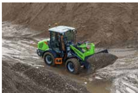
Wheel loader elektrik LiuGong 820TE menggunakan sistem baterai LFP 70.5 kWh.
