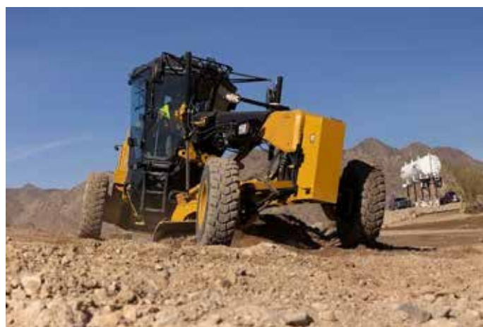
Grader 150 bergabung dengan platform Next Generation dengan opsi-opsi joystick dan tuas kontrol serta transmisi baru 9 kecepatan.
