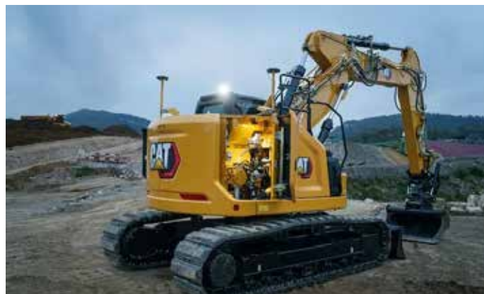
Excavator ini ditenagai oleh engine Cat C3,6 yang menghasilkan 99 kW (133 hp), dengan mode-mode Smart, Eco dan Power yang dapat dipilih oleh operator
